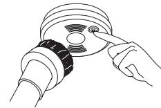
**ADVARSEL:** Det må ikke testes med åpen flamme, da dette kan skade brannvarsleren samtidig som det kan være fare for omgivelsene. Vi anbefaler ikke testing med røyk, da dette kan være misvisende hvis ikke riktig testeutstyr benyttes. Testknappen tester samtlige nødvendige funksjoner i brannvarsleren.
