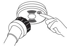
**VARNING:** Testa inte med öppen låga, detta kan skada brandvarnaren samt innehålla fara för omgivningen. Vi rekommenderar inte test med rök eftersom detta kan vara missvisande om inte korrekt testutrustning används. Testknappen testar samtliga nödvändiga funktioner i brandvarnaren.
