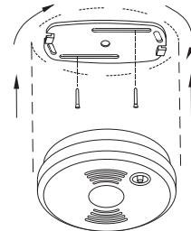
**Hinweis:** Vor dem Montieren der Halterung die Reichweite des Funk-Rauchwarnmelders an der vorgesehenen Montagestelle testen. Ist die Reichweite nicht groß genug, den Standort eines oder mehrerer Geräte probeweise ändern (siehe weiter unter *Test und Wartung*).
