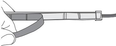
3. Kiinnitä LED-lista metallirenkaaseen, aloita kiinnitystangosta ja aseta LED-lista metallirenkaan ympärille niin, että päät ovat vastakkain kiinnitystangon kohdalla.
