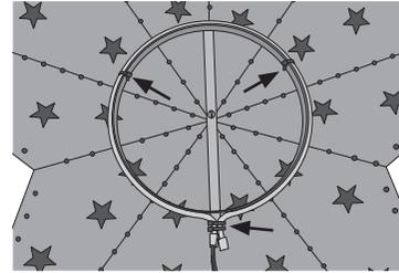
5. Käytä mukana tulevia vedonpoistosankoja ja ruuveja ja kiinnitä johto kiinnikkeeseen kuvan osoittamalla tavalla.
