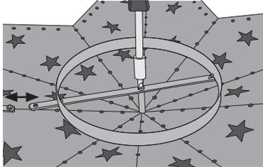
2. Das Abdeckklebeband von der LED-Leiste ziehen.
