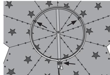
5. Die mitgelieferten Zugentlastungsbügel und Schrauben benutzen und das Kabel wie in der Abb. beschrieben an der Halterung befestigen.
