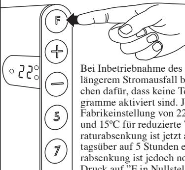
Bei Inbetriebnahme des Adax Neo oder nach längerem Stromausfall blinkt das Display als Zeichen dafür, dass keine Temperaturreduktionsprogramme aktiviert sind. Jetzt hat der Thermostat die Fabrikeinstellung von 22°C für Normaltemperatur und 15°C für reduzierte Temperatur. Die Temperatursenkung ist jetzt auf nachts 7 Stunden und tagsüber auf 5 Stunden eingestellt. Die Temperatursenkung ist jedoch noch nicht aktiviert. Durch Druck auf "F" in Nullstellung bringen
