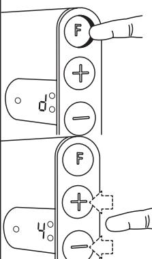
Ustawić prawidłowy dzień tygodnia poprzez naciśnięcie przycisku „F” aż na wyświetlaczu pojawi się „d” (d = dzień). Naciśnąć przyciski  $\Delta$  lub  $\nabla$ , aż zostanie wyświetlona odpowiednia cyfra.
