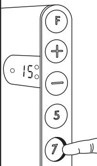
Zu dem Zeitpunkt, ab dem die Temperaturabsenkung gewünscht wird, "7" drücken bis das Display 15°C anzeigt. Jetzt bestätigt die grüne Lampe (B) durch schwaches Blinken die Aktivierung der Absenkung. In den folgenden 7 Stunden wird die Temperatur auf 15°C abgesenkt. Dieser Vorgang wird sich jeden Abend zum gleichen Zeitpunkt wiederholen.
