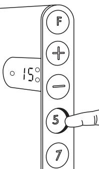
Zu dem Zeitpunkt, ab dem die Temperaturabsenkung gewünscht wird, "5" drücken, bis das Display 15°C anzeigt. Jetzt bestätigt die grüne Lampe (A) durch schwaches Blinken die Aktivierung der Absenkung. In den folgenden 5 Stunden wird die Temperatur auf 15°C abgesenkt. Dieser Vorgang wird sich an den Wochentagen wiederholen. Samstags und sonntags erfolgt tagsüber keine Temperaturabsenkung.
