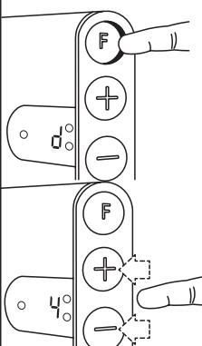
Auf "F" drücken, bis das Display "d" (day = Tag) anzeigt. Dann auf  $\Delta$  oder  $\nabla$  drücken, bis das Display die Zahl des gewünschten Tages anzeigt. Montag = 1, Dienstag = 2 usw. Durch Druck auf "F" die Einstellung beenden, ansonsten wird nach ca. 30 Sekunden die Einstellung automatisch gespeichert und beendet.
