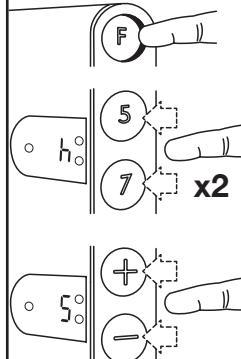
Bei gedrücktem "F" zweimal auf "7" oder "5" drücken, je nachdem welche Änderung gewünscht wird. "F" loslassen, sobald "h" (hour = Stunde) im Display aufleuchtet. Auf  $\Delta$  oder  $\nabla$  drücken und die Stundenanzahl für die gewünschte Dauer der Temperaturabsenkung einstellen.
