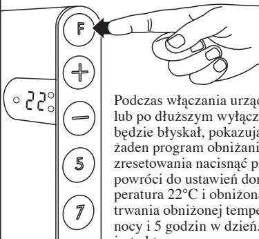
Podczas włączania urządzenia Adax Neo do pracy lub po dłuższym wyłączeniu zasilania, wyświetlacz będzie błyskał, pokazując, że nie jest aktywny żaden program obniżania temperatury. W celu zresetowania naciśnąć przycisk „F”, urządzenie DT powróci do ustawień domyślnych: komfortowa temperatura 22°C i obniżona temperatura 15°C. Czas trwania obniżonej temperatury wynosi 7 godzin w nocy i 5 godzin w dzień. Obniżanie temperatury nie jest aktywowane.
