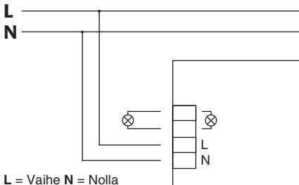
5. Asenna himmennin laiterasiaan ja kiinnitä se paikoilleen kahdella lukitusruuvilla tai asenna himmennin pinta-asennuksena asennuskehylsellä 36-1821 (ei sisällä).
