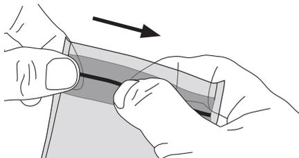
1. Laita suojattava laite pussiin. Purista pussi mahdollisimman tyhjäksi ilmasta.
