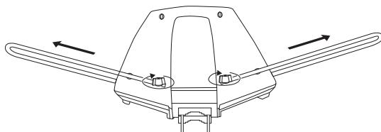
1. Die 4 Flügelschrauben lösen (2 an der Oberseite und 2 an der Unterseite).
