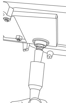
2. Das andere Ende des Antennenkabels und das 12-V-Kabel mit Stecker für 12-V-Steckdose an die Frequenzweiche anschließen.
