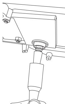
2. Den andre enden på kabelen og 12 V-kabelen med plugg kobles til delingsfilteret.
