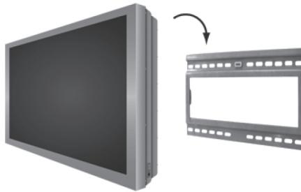
2. Slå inn sikkerhetslåsen på hver av festearmene for å forhindre at TV-apparatet løftes av uønsket. En hengelås kan brukes for å låse TV-apparatet slik at det ikke kan løftes opp.
