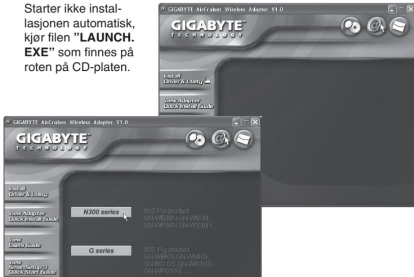
2. Klikk på ”**Install Driver & Utility**” og deretter på knappen ”**N300 series**” for å installere konfigurasjonsprogrammet.
