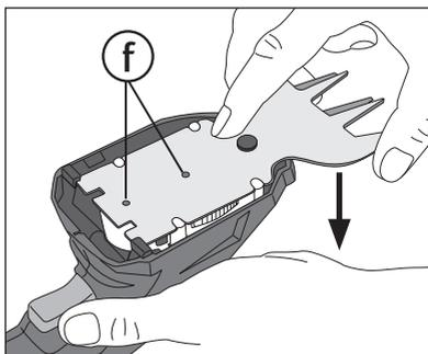
5. Tilpass bunnplaten til trimmeren og skyv deretter bunnplaten i pilens retning, som vist på bildet.
