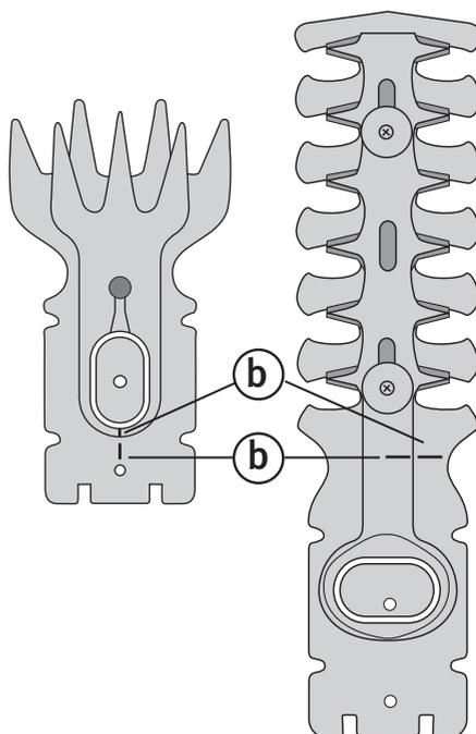
4. Montere knivene: Plasser først knivene inn under flikene i bakkant av trimmeren (e) og bøy deretter knivene ned slik at uttaket i knivene passer på opphøyningene (f). De må ligge tett mot trimmeren.
