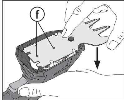
5. Die Bodenplatte in den Trimmer einsetzen. Dann die Bodenplatte gemäß der Abbildung in Pfeilrichtung schieben.
