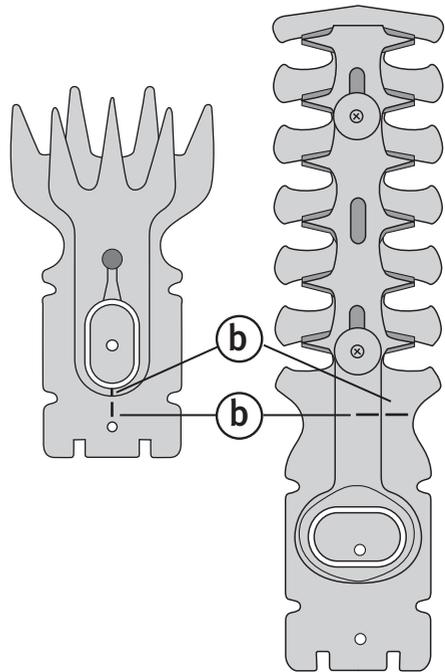
4. Montera kniven: Passa först in kniven under flikarna på bakkanten av trimmern (e) och vik sedan ner kniven så att urtagen i kniven passar på upphöjningarna (f) så att den ligger tätt mot trimmern.
