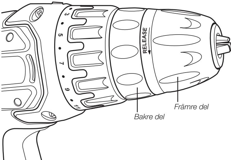
Håll fast den bakre delen med ena handen och vrid den främre delen med den andra handen för att dra åt eller lossa.
