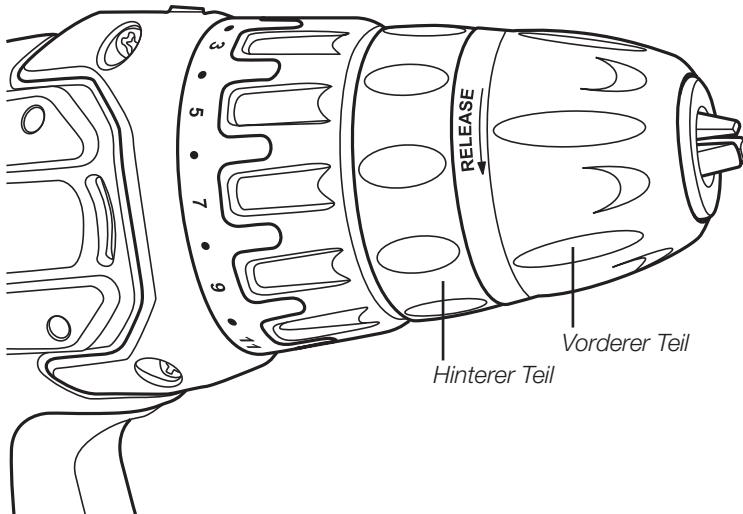
Den hinteren Teil mit der einen Hand festhalten und den vorderen Teil mit der anderen drehen, um das Bohrfutter festzuziehen oder zu lösen. Genau darauf achten, dass der Bohrer fest und mittig im Bohrfutter sitzt.
