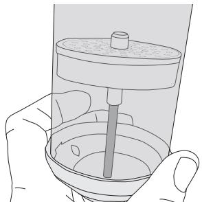
9. La pumpevispen stå i stativet (bortsett fra når det lengste sproytemunnstykket er montert på) når du har et avbrudd i arbeidet.
