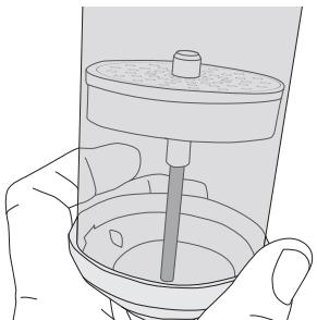
9. Das Gerät kann zwischen den Arbeitsvorgängen im Ständer abgestellt werden (jedoch nicht, wenn die längste Spritztülle benutzt wird).
