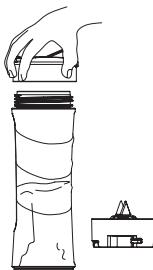
3. Den Mixbehälter dann auf den Kopf drehen und mit dem Uhrzeigersinn am Motorteil fest.
