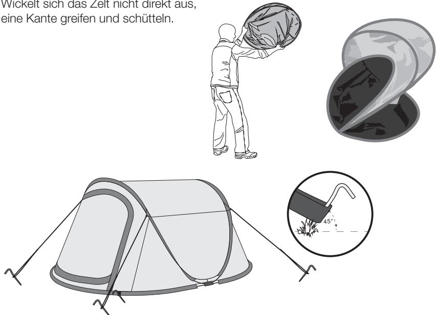
4. Das Zelt mit 4 Heringen (7) verankern, dazu diese durch die vier Löcher (8) neben dem Bodenbogen an der Außenseite in den Erdboden drücken.
