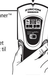
**ADVARSEL** Verktøy som detekterer elektriske felt kan i enkelte tilfeller mislykkes med detekteringen av strømførende ledninger. Dette gjelder hvis det er fukt i veggen eller omgivelsene, når ledningene ligger dypere enn 50 mm inn i veggkonstruksjonen, in betong, inni ledningsrør, bak puss på veggplater eller hvis veggmalingen eller tapet inneholder metall.
