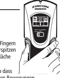
Bei tiefer in dickeren Wänden gelegenen Balken wird die Mitte des gefundenen Balkens mit nur einem oder zwei Säulen auf dem Signalstärkenanzeiger angezeigt, und nur die mittleren Segmente der Zielanzeigesäulen leuchten auf. Falls Sie danach weiterhin keinen Balken orten können, stellen Sie bitte auf DeepScan® um.
