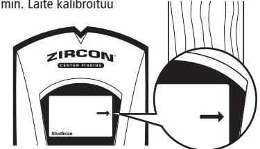
**Peulattiat ja kipsilevyillä peitetty vaneriseinät:** Käytä koolinkinetätilaa (DeepScan®) ja liikuta laitetta hitaasti pistaa pitkin. Signaalivoimakkuuden osoitin näyttää ehkä vain yhtä tai kahta pilaria paksun pinnan läpi.
