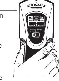
**VAROITUS** Sähköisen kentän paikannin ei välttämättä paikanna jännitteellistä johtoa jos mitattavalla pinnalla on kosteutta tai johdot ovat syvemmällä kuin 50 mm. Myös johtojen suojarakenteet, sisään betoniin, vaneri sekä metallia sisältävät pinnoitteet saattavat häiritä mittausta tai antaa epätarkan tuloksen.
