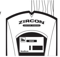
Fortsätt att föra verktyget över ytan tills tre staplar i signalstyrkeindikatorn visar att regeln mittpunkt är detekterad. När mittpunkten på en regel är lokaliseras kommer en ljudsignal att höras och tre staplar på signalstyrke-indikatorn, staplarna mittensymbolerna på föremåls-indikatorn samt centrum-indikeringen kommer att visas på skärmen samtidigt som en ljusstråle "SpotLight® Pointer" markerar mitten på regeln.
