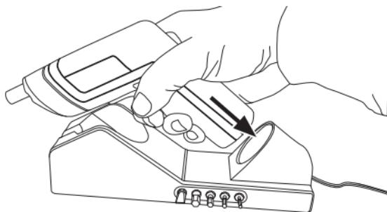
3. Die Ladestation an eine Steckdose anschließen. Die rote Ladeanzeige (4) leuchtet während des Ladevorgangs und erlischt, wenn der Akku aufgeladen sind, dies dauert etwa 4–6 Std.
